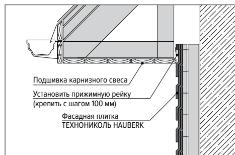
Рис. 9.1. Монтаж верхнего ряда под карнизным свесом
