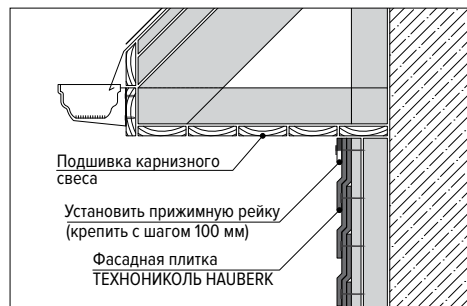
Рис. 9.2. Монтаж верхнего ряда под карнизным свесом
